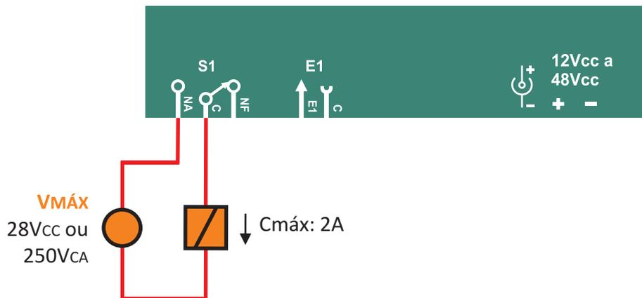
SAÍDA PARA COMANDO POR TENSÃO - CONTATO **NF**
