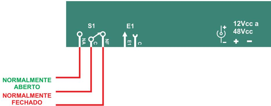
SAÍDA PARA COMANDO POR TENSÃO - CONTATO **NA**
